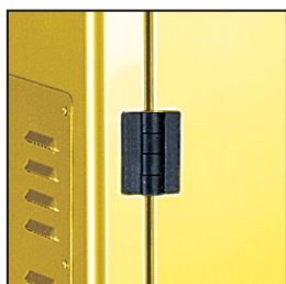
Cerniera esterna antivandalo con apertura anta di 180° e spina inox AISI 303.
